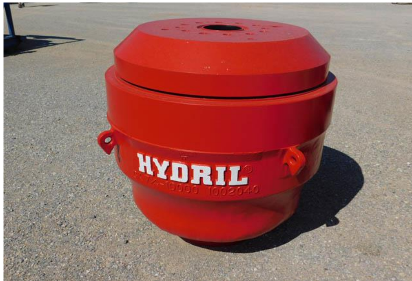
10 Сурет - «Хайдрилл» компаниясының лақтыруға қарсы жабдығы.
